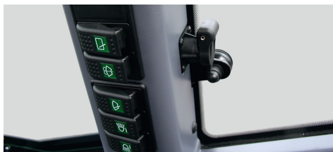
Gecentraliseerd schakelaarsveld, stopcontact met gelijkstroom
