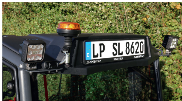
Er is ook ruimte voor maximaal vier werklichten aan de achterkant; als alternatief kan één koplamp worden vervangen door een roterende zwaailamp.
