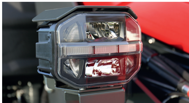
De koplampen zijn LED en uitgerust met dagrijverlichting.
