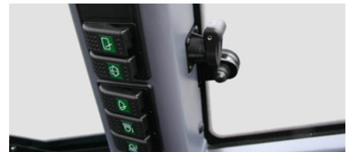
Gecentraliseerd schakelaarsveld, stopcontact met gelijkstroom
